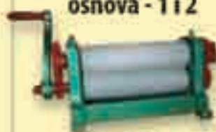
Komplet - Ručni valjci za proizvodnju satnih osnova - 1 i 2
